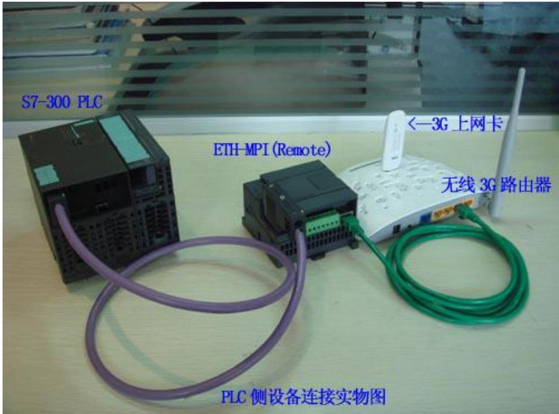
PLC 侧的 ETH-MPI(Remote)实物图及设置:
