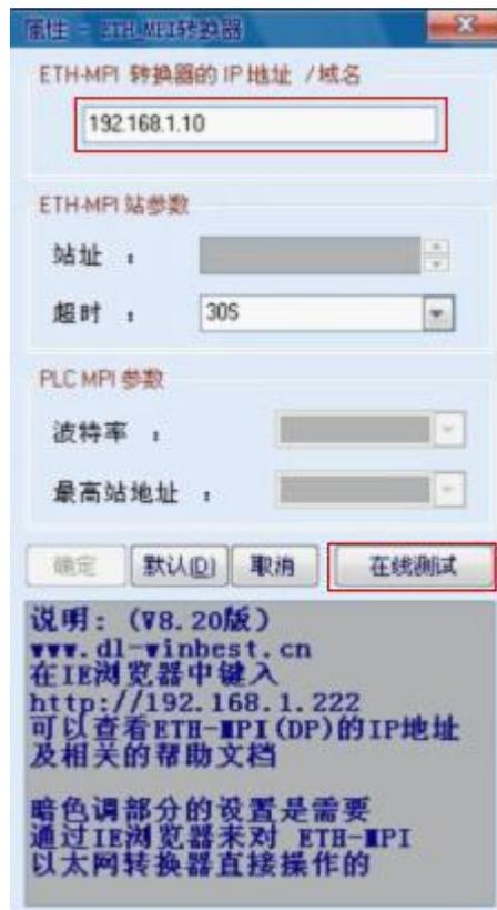
4. 可通过[在线测试]按钮测试填入的 IP 地址是否与该转换器完全一至。如果不能与该转换器正常通讯，需在 IE 浏览器中键入 <http://192.168.1.222> 来查看该转换器的 IP 地址，然后修改“设置 PGPC 接口”中该转换器的 IP 地址。
