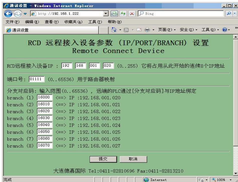
1. RCD 远程接入设备 IP : 它将占用从此开始的连续 8 个 IP 地址; 例如填入 192.168.1.20, 则 192.168.1.20/21/22/23/24/25/26/27 都被该 RCD 模块占有
